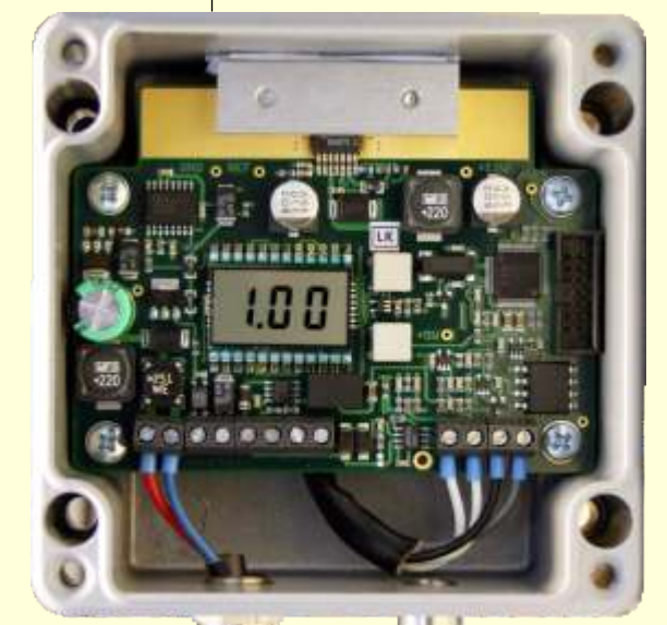
Transmitter TOM 420R Elektronik, LCD-Anzeige und Bedientasten
